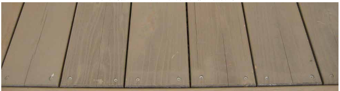
屋外曝露6ヶ月（左部分無塗装品、右部分塗装品）
