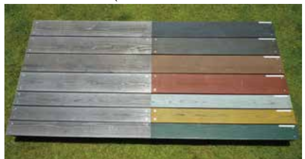
屋外曝露1年6ヶ月（左部分無塗装品、右部分塗装品）
