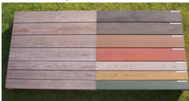
屋外曝露6ヶ月（左部分無塗装品、右部分塗装品）
