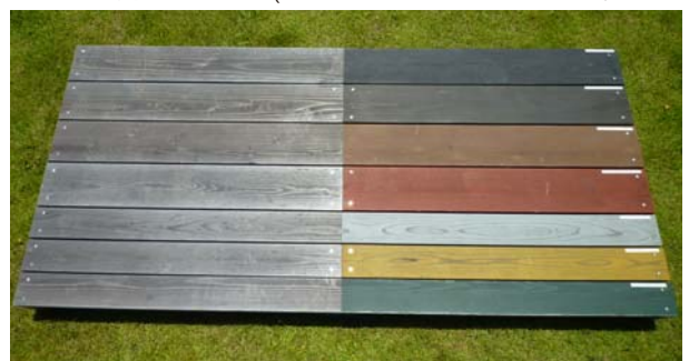
屋外暴露1年6ヶ月(左部分無塗装品、右部分塗装品)
