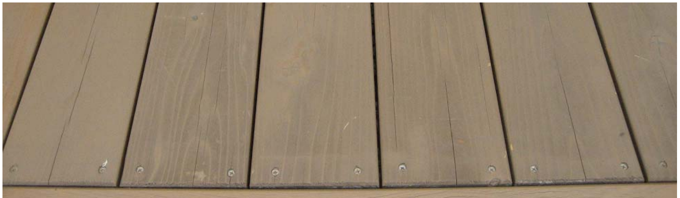
屋外暴露6ヶ月(左部分無塗装品、右部分塗装品)
