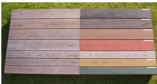
屋外暴露6ヶ月(左部分無塗装品、右部分塗装品)
